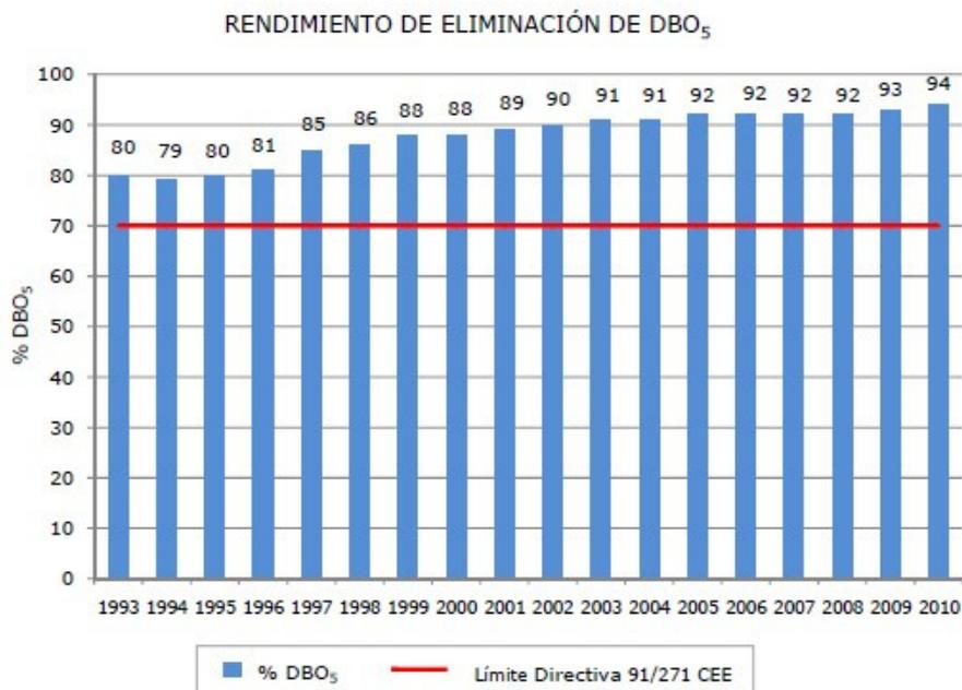
Figura 10. Evolución de los rendimientos de eliminación de DBO<sub>5</sub>
